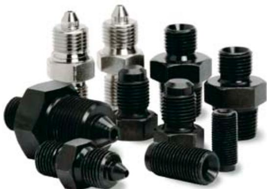
En cualquier situación es esencial disponer de conexiones seguras y fiables. La amplia gama de adaptadores CEJN incluye una gran variedad de estas conexiones, adecuadas para la mayoría de acoplamientos y espigas. Todos los adaptadores se fabrican en acero cincado negro, con una presión de trabajo que varía entre los 100 y 300 MPa (consulte la tabla de productos para ver más detalles sobre cada adaptador).
